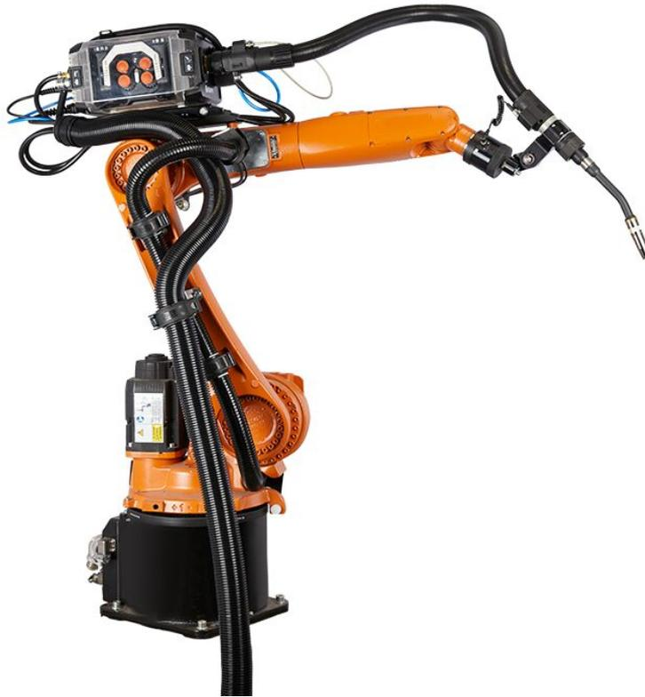
Kemppi ofrece paquetes de pistolas robóticas con diseños de brazo robótico de articulación hueca y no hueca. El sistema de pistola de soldar perfecto para soldadura por arco robótico consta del cuello de pistola con soporte para puntas, una boquilla de gas y un juego de cables. Una pistola robótica se puede instalar en un soporte de montaje para pistolas Kemppi adecuado.
