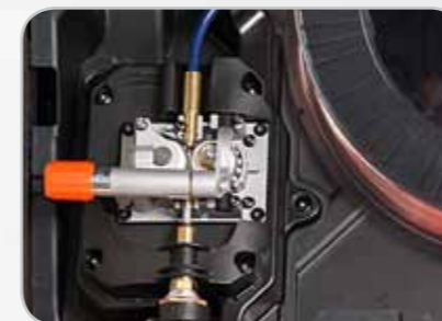
Kempact 181/251 -malleissa on 2-pyöräinen GT02-langansyöttömekanismi.
