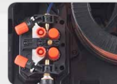
Kempact 253/323 -malleissa on 4-pyöräinen DuraTorquelangansyöttömekanismi.
